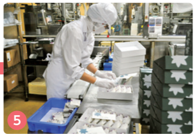
5 いぶつが入ってないか金属探知機で検査しながら人の手で箱詰めします。
