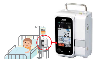
輸液ポンプ (薬を決まった量・速さで入れるための装置)
